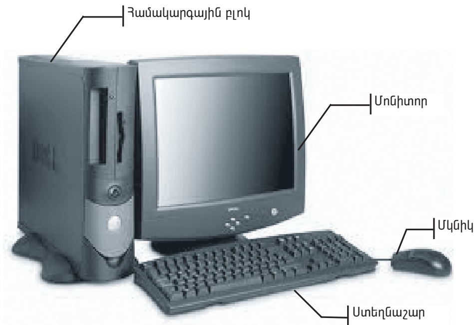
Նկ. 2.2. Անհատական համակարգչի հիմնական կառուցվածքային բաղադրիչները
